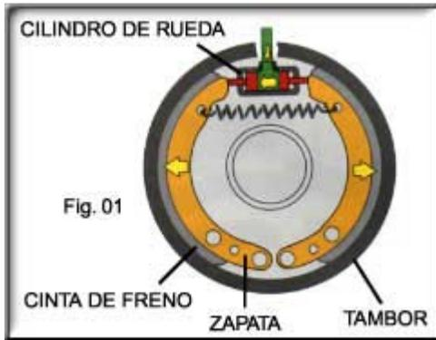
El cilindro tiene dos émbolos que salen hacia afuera y aprietan las balatas (cinta de freno) sobre el tambor, deteniendo su giro.
