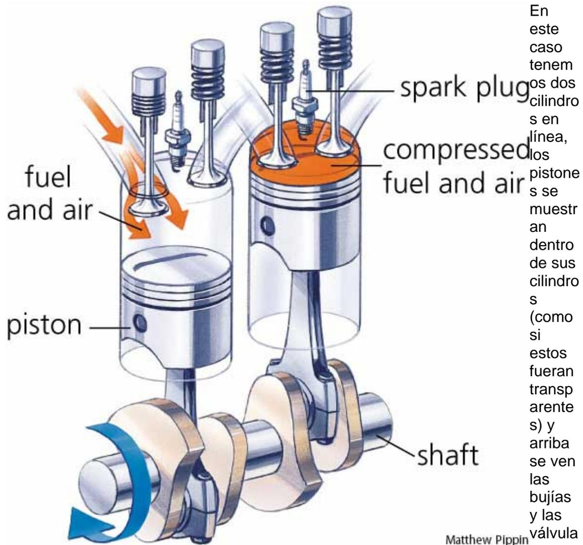
En este caso tenemos dos cilindros en línea, los pistones se muestran dentro de sus cilindros (como si estos fueran transparentes) y arriba se ven las bujías y las válvulas.
